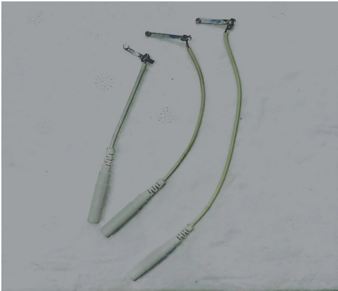
图 2 经皮耳穴迷走神经刺激装置焊接铁片
